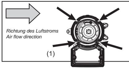
1. Lösen Sie die vier Schrauben.
