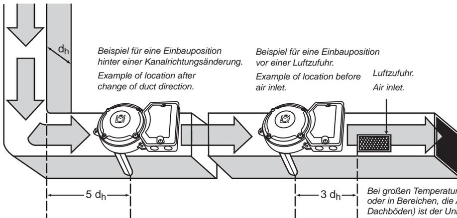
Bei großen Temperaturschwankungen, z. B. im Außenbereich oder in Bereichen, die Außentemperaturen ausgesetzt sind (Dach, Dachböden) ist der Uniguard-Rauchmelder zu isolieren, siehe Abs. 8.
