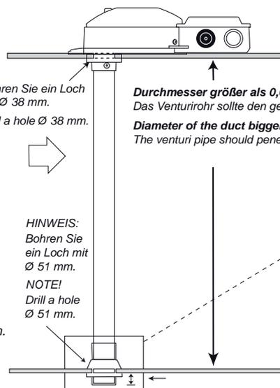
Bohren Sie ein Loch mit  $\varnothing$  38 mm.
