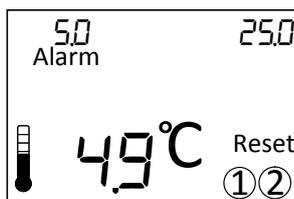
Ist der Alarmmodus durch Drücken der Reset-Taste wieder auf „Normaltemperatur“, werden die Relais zurückgesetzt und die mittlere Taste geht zurück in die Menu-Funktion.
