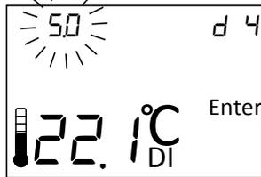
Nun beginnt der Sollwert für die Wärmehaltung (Nachtbetrieb) in der oberen rechten Ecke des Displays zu blinken. Ändern Sie den Wert mit ▲ oder ▼ bis zum gewünschten Wert und bestätigen Sie mit Enter (↵). Fertig!
