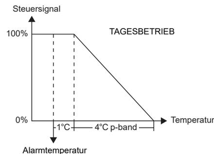
Der Tagesbetrieb wird aktiviert, indem Klemme 9 und 12 kurzgeschlossen werden. Im Tagesbetrieb steht in der oberen rechten Ecke des Displays d 4 sowie DI (unter °C) leuchtet, um anzuzeigen, dass der digitale Eingang (DI) kurzgeschlossen ist.
