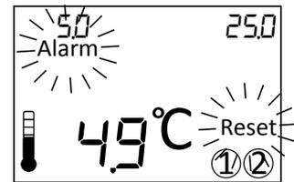
Die Alarmtemperatur und der Sollwert für die Wärmehaltung lassen sich jederzeit, auch im Alarmmodus, verändern. S. Abschnitt 8.
