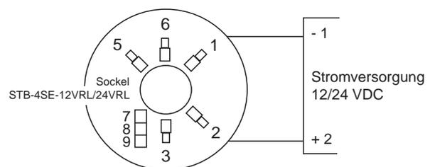
Die Alarmrelaiskontakte werden im spannungslosen bzw. Alarmzustand angezeigt. Alarmrelais: abwechselnd potentialfreier Kontakt, max. 24 V, 1 A
