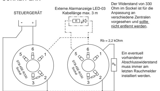
Anschluss für Rauchmelder ST-P-OM mit Relais-Sockel STB-4SE-12VRL oder STB-4SE-24VRL
