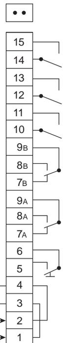
Die Relaisausgänge werden im ausgeschalteten/Alarm-Modus angezeigt.
